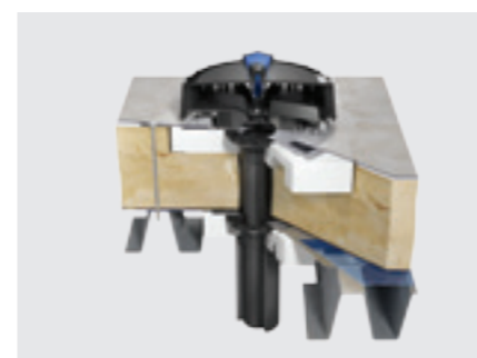
Näide 2 Katusekatte rollmaterjali ja Geberiti aurutõkkega tihendatud kergkatus
