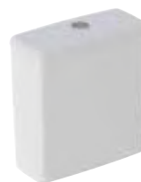
Geberit Selnova Square keraamiline loputuspaak, kahe-süsteemne loputus, veeühendus küljel, pööratav, WC Rimfree jaoks
